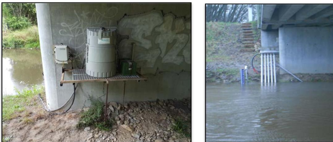
Figure 4 : Station amont (EDF-INRA), à gauche : le préleveur installé par l'INRA, À droite : les sondes et le dispositif de suivi installés par EDF.
