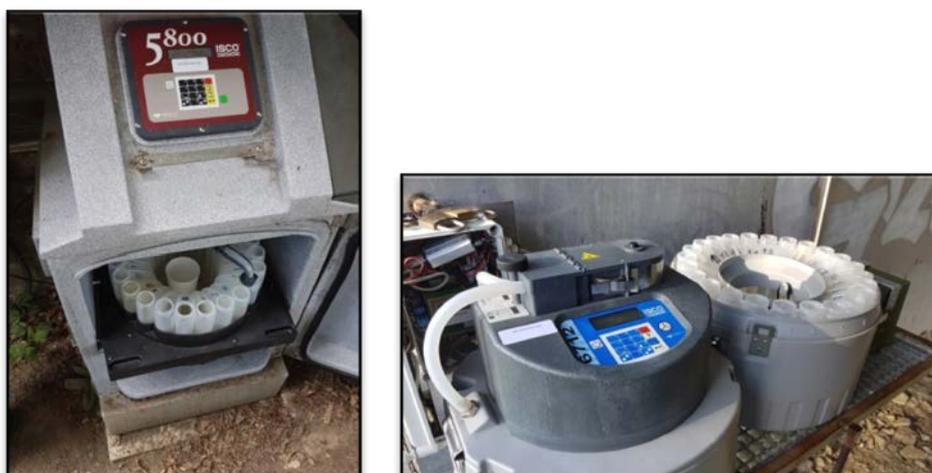
Figure 6 : A gauche, préleveur réfrigéré à la station aval (pont de Signy), à droite préleveur non réfrigéré sur la station amont (pont de Virey)
