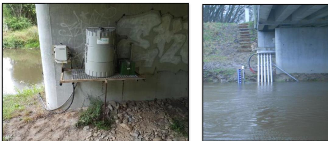
Figure 3 : Station amont (EDF-INRA), à gauche : le préleveur installé par l'INRA, À droite : les sondes et le dispositif de suivi installés par EDF.
