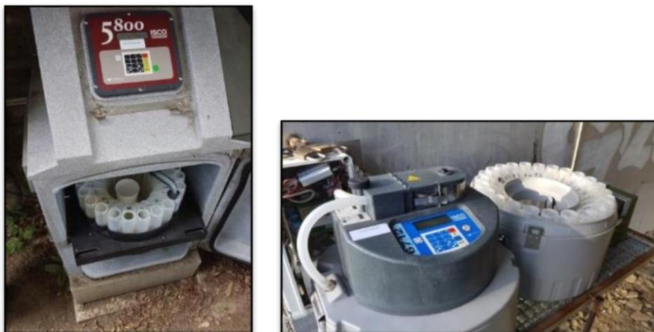
**Figure 4 : A gauche, préleveur réfrigéré à la station aval (pont de Signy), à droite préleveur non réfrigéré sur la station amont (pont de Virey)**
