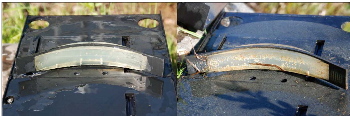
Figure 10. Photographie de la lentille du DIDSON propre à gauche, et d'une lentille couverte de pollen de pin dérivant dans le cours d'eau à droite (Lilja et al. , 2010)
