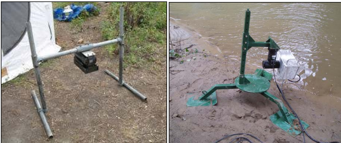
Figure 12. Différents types de supports de fixation du DIDSON : à gauche, une structure en H (Mercer et Wilson, 2009) ; à droite, un trépied (Pipal et al. , 2010b)
