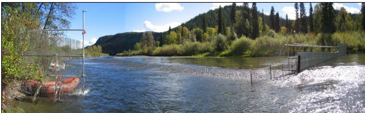
Figure 13. Utilisation d'un barrage déflecteur dans le cadre d'un suivi acoustique avec le DIDSON sur la rivière Horsefly, photographie de J. Lilja (Cronkite et al. , 2006)
