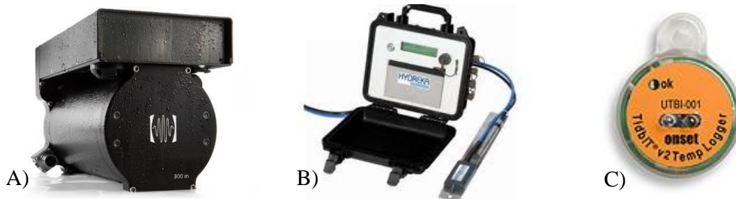
Figure 7. Dispositifs de suivi installés sur la Sélune. A) La caméra acoustique DIDSON ; B) Courantomètre Hydreka Mainstream IV ; C) Logger de température Tidbit
