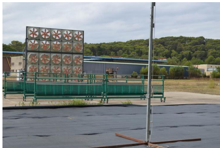
Figure 2 : Photographie du banc d'essai EoleDrift avec la végétation artificielle en conformation « début de végétation »
