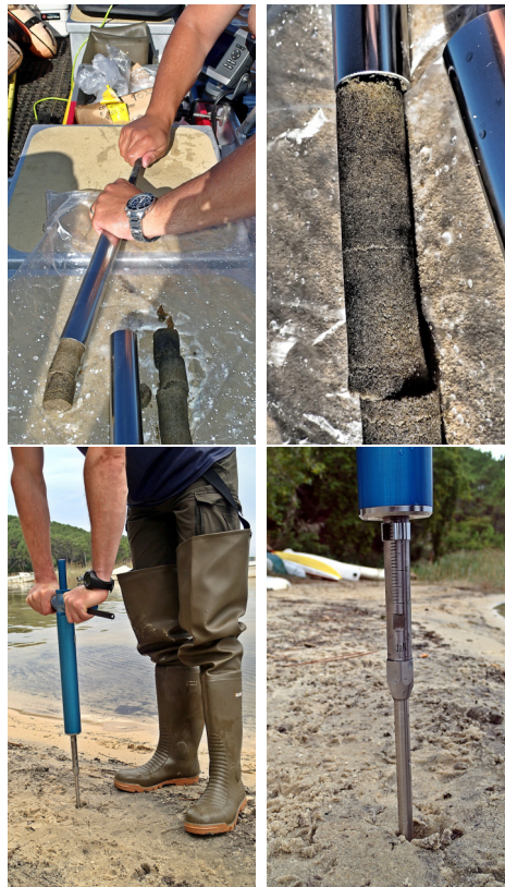
FIGURE 4 – Carottier pour l'échantillonnage des sédiments (en haut) (photos : V. Bertrin). Pénétrromètre manuel (en bas) (photos : S. Moreira), septembre 2020
