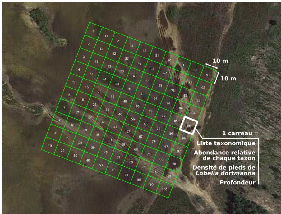
FIGURE 5 – Schéma représentatif d'un carroyage constitué de 100 carreaux contigus de 10m de côté, et détail des observations et mesures réalisées sur la flore aquatique dans chaque carreau
