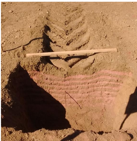
Figure 3 : Tassement d'un sol (source : INRAE).
