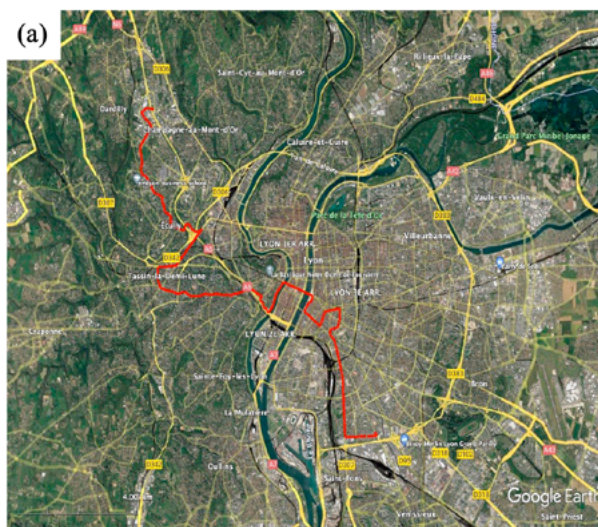
1 (a) Route optique utilisée pour la première acquisition de données DAS (24 km). Source des données : Grand Lyon THD et Métropole de Lyon. (b, bas) 60 secondes de données sur les 24 km de fibre. (b, haut) Zoom sur les 5 premiers kilomètres de fibre. Traitement et images effectués par D. Nziengui (Febus Optics/Université Grenoble Alpes).
