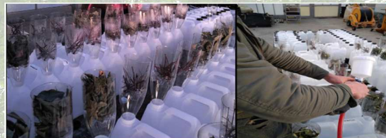
(2) Expérience 1 : Simulation des pluies artificielles en serre à l'aide d'un pistolet pulvérisateur et un compresseur à pression constante
