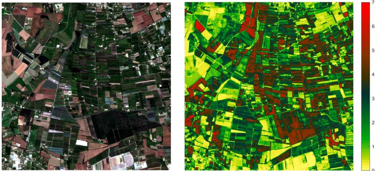
**Figure 8 :** Exemple d'application des réseaux de neurones sur une image Sentinel-2 (région de la Camargue). À gauche, image en « vraie couleur » (RGB) ; à droite, carte de LAI estimée.
