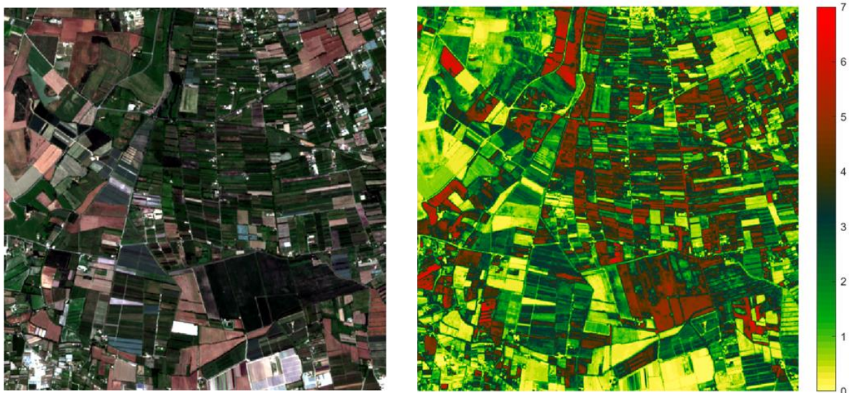
Figure 8 : Exemple d'application des réseaux de neurones sur une image Sentinel-2 (région de la Camargue). À gauche, image en « vraie couleur » (RGB) ; à droite, carte de LAI estimée.
