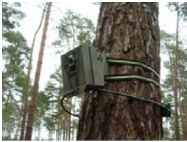
Figure 1. La caméra GameSpy modèle M-80XT de la marque Moultrie disposée dans son boîtier de protection sur un arbre à 2 mètres de hauteur.
