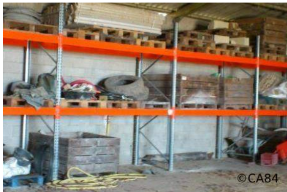
FIGURE 10 – Photo de la surélévation du petit matériel avec des racks
