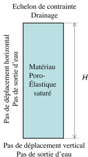
Figure 1. Consolidation œdométrique
