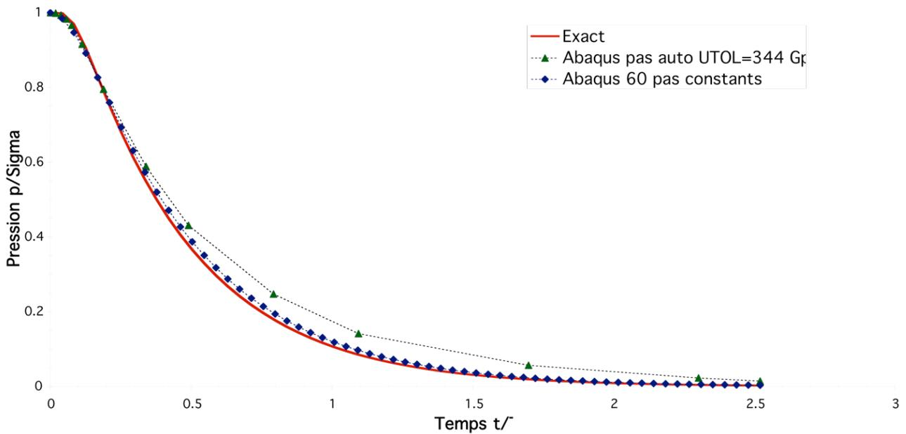
Figure 5. Pression interstitielle adimensionnelle en fonction du temps adimensionnel, comparaison des résultats numériques obtenus avec Abaqus (méthodes à pas constants et à pas variables) et de la solution exacte (séries infinie calculée avec 100 termes).
