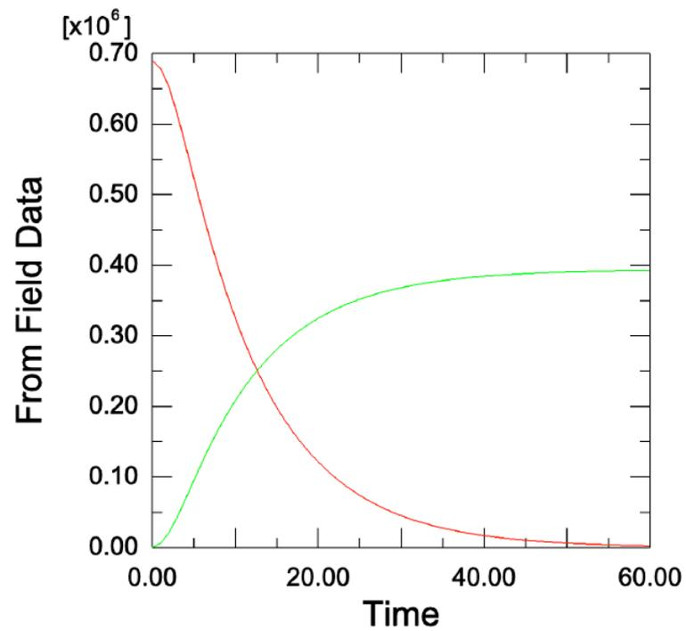
Figure 3. Pression interstitielle et contrainte effective équivalente de Von-Mises en fonction du temps, résultats numérique obtenu avec Abaqus, méthode à pas constants.
