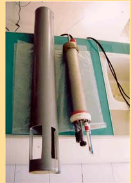
Figure E1. Sonde océanographique multiparamétrique et son tube support pour pouvoir l'installer dans la rizière (Cary 2005)
