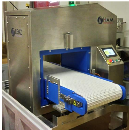
Figure 1 : Scanner à induction magnétique (Ham-Inspector II™)
