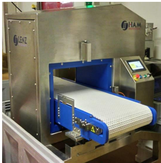
Figure 1 : Scanner à induction magnétique (Ham-Inspector II™)
