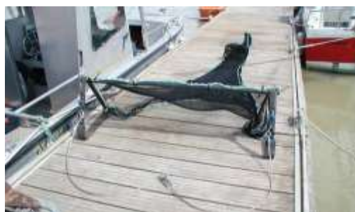
Figure 3 : Chalut à perche de 1m50
