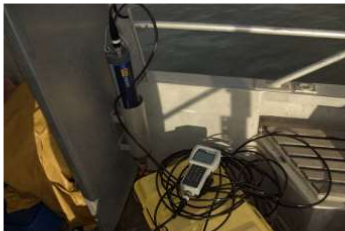
Figure 6 : Photo de la sonde multi-paramètres et du boîtier de lecture de surface. (Photos Collection INRAE)
