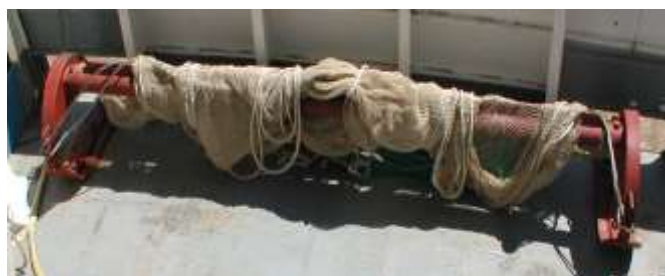
Figure 2 : Chalut à perche de 3 mètres
