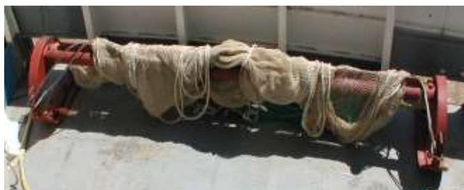
Figure 2 : Chalut à perche de 3 mètres
