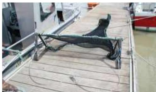
Figure 3 : Chalut à perche de 1m50
