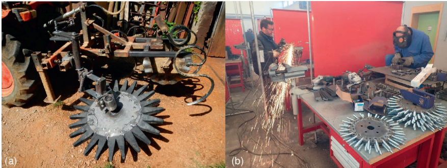
Figure 6.2. Étoile de binage conçue à l'Atelier paysan et qui permet de désherber mécaniquement dans les rangs de vignes ; (a) modèle d'étoile de binage qui s'adapte facilement à différents supports ; (b) les étoiles en cours de fabrication lors d'une formation à l'Atelier paysan (L'Atelier paysan, 2021)
