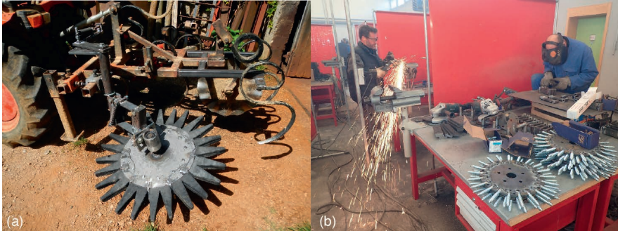
Figure 6.2. Étoile de binage conçue à l'Atelier paysan et qui permet de désherber mécaniquement dans les rangs de vignes ; (a) modèle d'étoile de binage qui s'adapte facilement à différents supports ; (b) les étoiles en cours de fabrication lors d'une formation à l'Atelier paysan (L'Atelier paysan, 2021)
