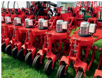
Figure 6.1. Détail d'un broyeur inter-rang Eco-Mulch (Eco-Mulch et Arvalis, 2019) (crédit : C. Huyghe)
