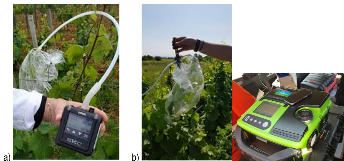
Figure 5 : Collecte dynamique (sous aspiration) des COVs au vignoble : a) sur capteur Tenax®, à l'intérieur du sac et relié à une pompe manuelle b) sur NeedleTrap, à l'intérieur du sac et relié à une pompe manuelle) avant désorption et analyse in situ sur GC-MS portative (Torion PerkinElmer) (essai Bourgogne UMR AE 2019)
