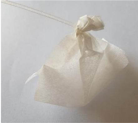
**Figure 6 :** Conditionnement des billes de milligel par ensachage (Sachet de thé fermé par un collier de serrage)
