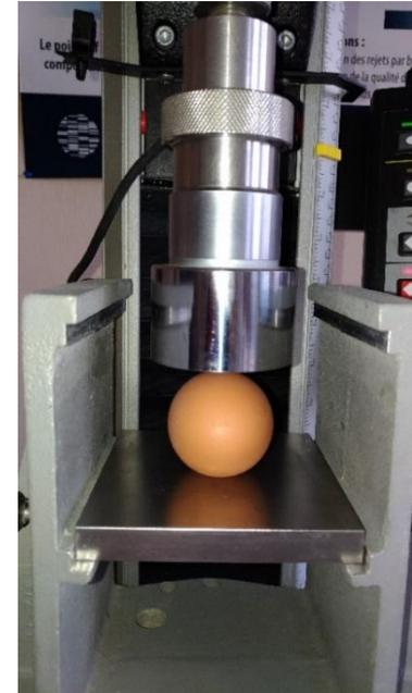
Rigidité (**Sd**) (stiffness en N/mm) : Déformation de la coquille obtenue sous une charge donnée
