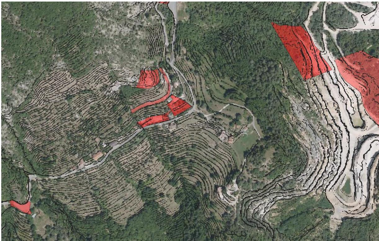
La figure ci-dessus illustre une zone de test avec les parcelles endommagées en rouge. Les zones en forêt et les terrasses en prairie sont bien visibles. Les murs de soutènement détectés par le filtre appliqué
