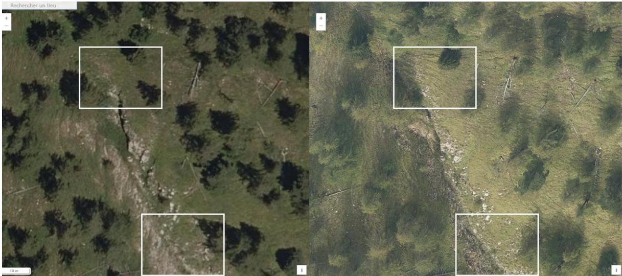
Un troisième exemple est situé dans une parcelle de probabilité de dommage  $\leq 0.2$ . Nous voyons néanmoins en comparant les deux images qui suivent que l'aléa de transfert fort ( $\geq 4$ ) est bien la cause d'un mouvement de matériaux qui traverse le virage d'une route amont pour rejoindre une route aval en érodant des matériaux en place, suivre cette route sur 30m puis s'épandre dans une pente, ce qui explique que ce ne soit pas une zone d'accumulation d'après le modèle IRIP.
