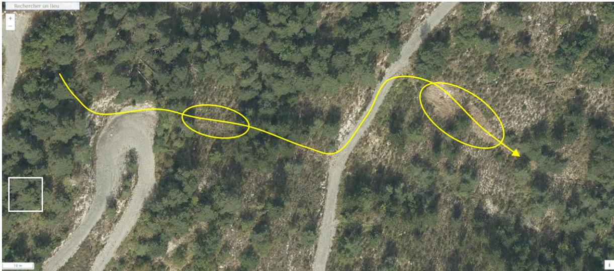
Un dernier exemple montre des étalements de matériaux en travers d'une route en aval des zones de transfert forts  $\geq 4$  IRIP (pixels rouge de 25m). L'effet d'ombrage peut perturber le calcul des indices utilisé par le modèle de probabilité de dommage.
