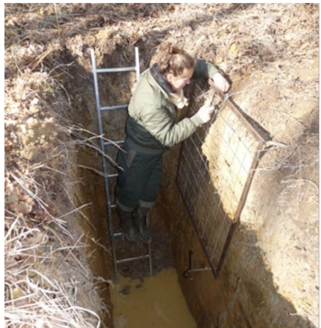
↑ Figure 2. Relevé de la densité initiale de racines aux différentes profondeurs des fosses à l'aide d'une grille maillée (mars 2011).
