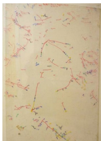
← Figure 1. Le rhizotron, vitre insérée verticalement sur l'une des faces de la fosse et jusqu'à 2 m de profondeur.
