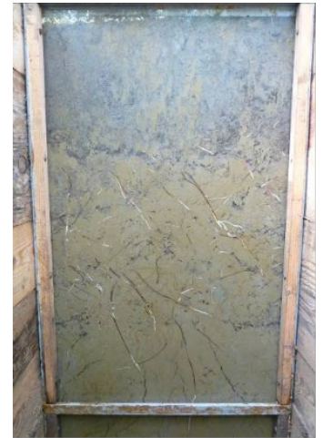
← Figure 1. Le rhizotron, vitre insérée verticalement sur l'une des faces de la fosse et jusqu'à 2 m de profondeur.
