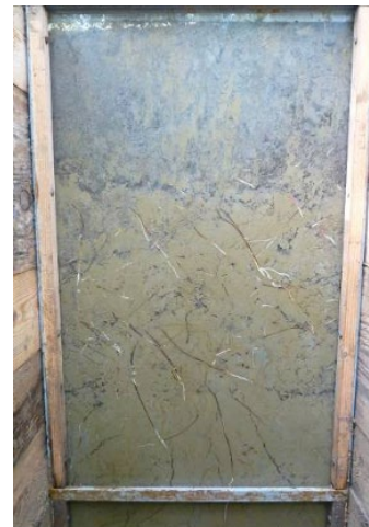
← Figure 1. Le rhizotron, vitre insérée verticalement sur l'une des faces de la fosse et jusqu'à 2 m de profondeur.
