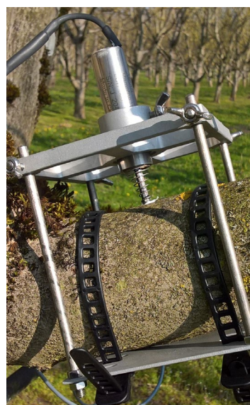
Détail d'un dendromètre LVDT – PépiPIAF pour la mesure en continu des variations de diamètre de tige (ou branche)
