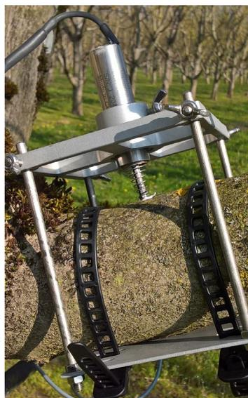
Détail d'un dendromètre LVDT – PépiPIAF pour la mesure en continu des variations de diamètre de tige (ou branche)
