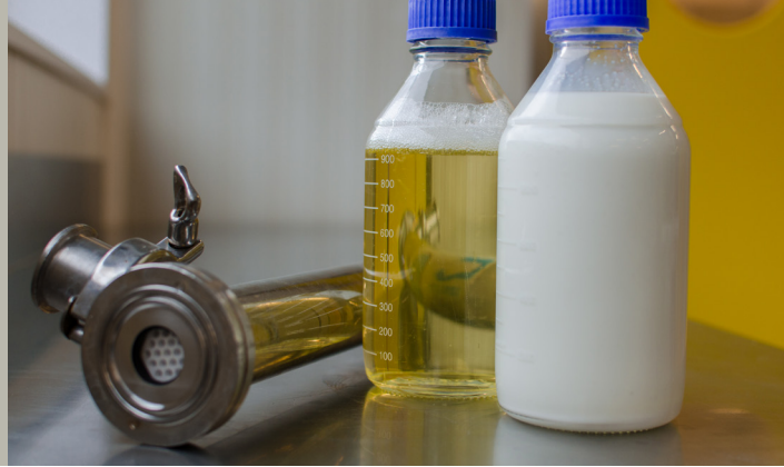
© Eric Beaumont INRAE Rennes Membrane céramique de microfiltration pour la séparation des protéines du lait, protéines du lactosérum à gauche et micelles de caséines à droite.
