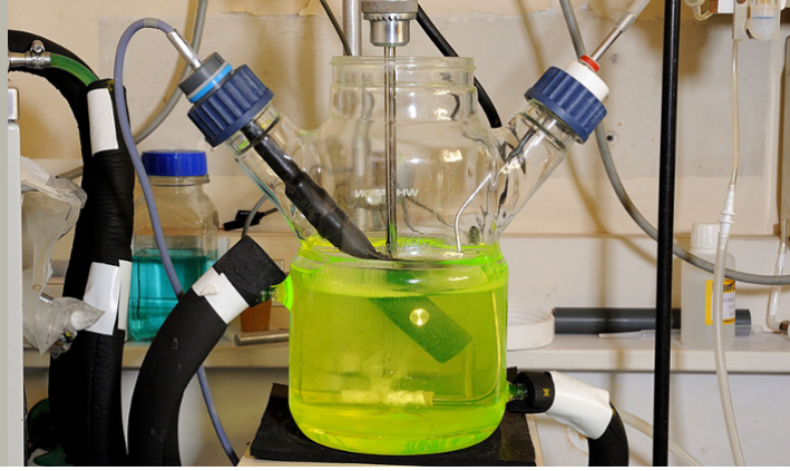
Dircom Cnam ©Sandrine Villain - Détermination du coefficient de transfert d'oxygène dans un bioréacteur
