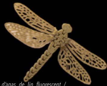
©Claire Mayer - Poudre d'anas de lin fluorescent / filament renforcé avec les anas de lin fluorescents / objet (libellule) imprimée en 3D
