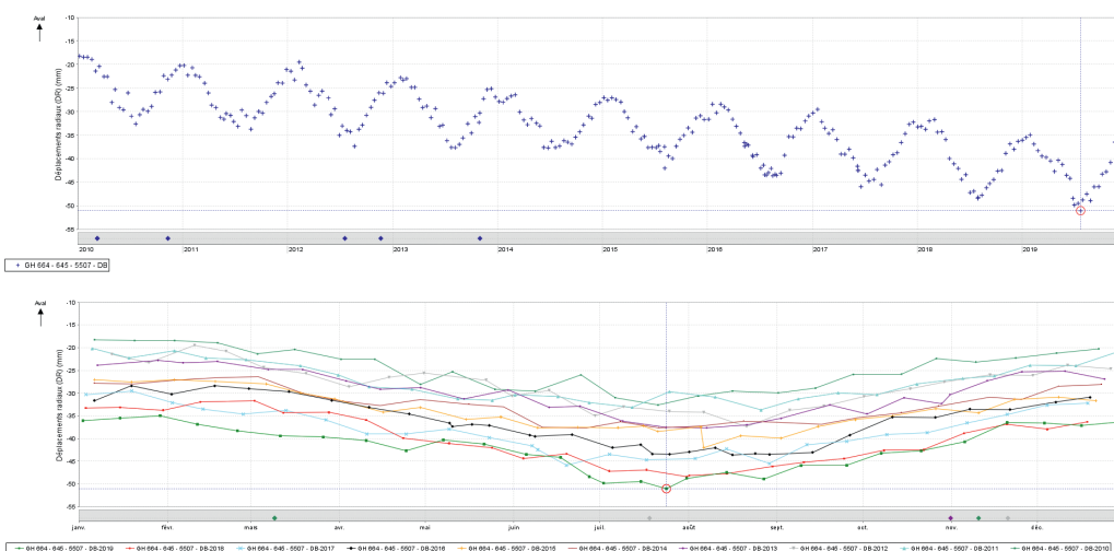
Figure 11.10 – Représentation du déplacement radial du plot central d'un barrage-voûte affecté d'une pathologie d'alcali-réaction : en fonction du temps (graphique du haut) et sur des périodes annuelles (graphique du bas) / © EDF
