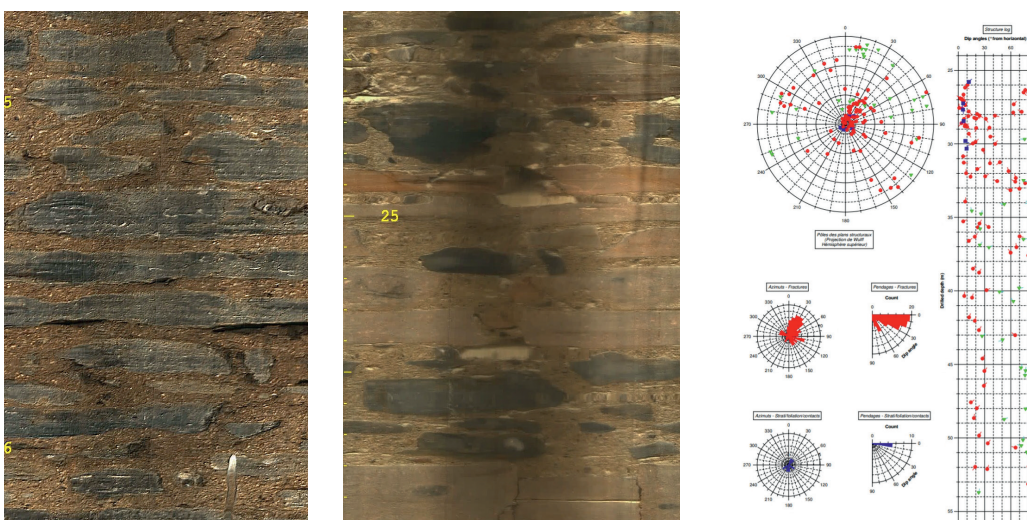
Figure 5.6 – Imagerie en forage, barrage de Pont-et-Massène / © Lim Logging
