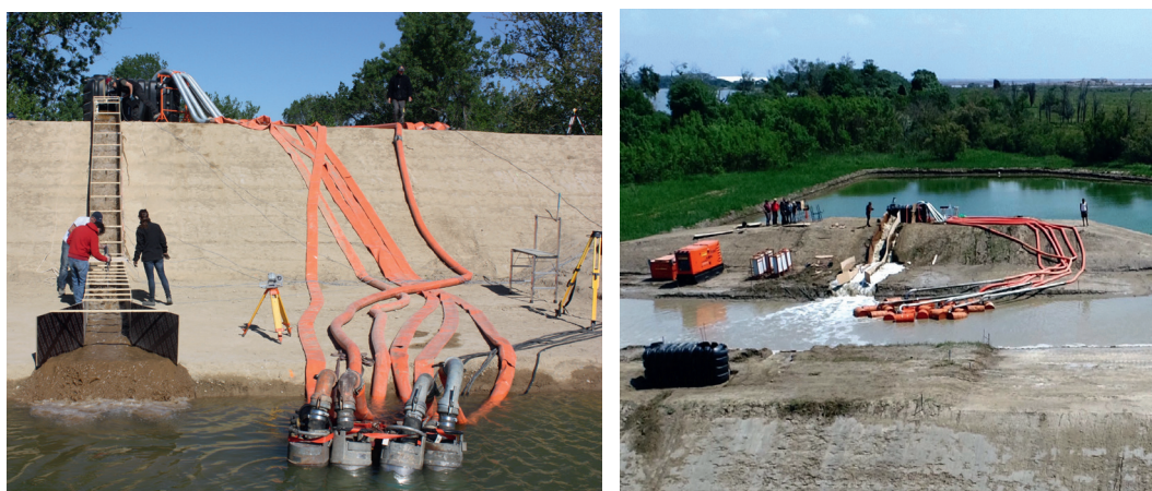
Figure 7.14 – Évaluation de la résistance in situ à la surverse – a) Essai sur démonstrateur du projet DigueElite (Vidourle, 2016), b) Essai sur plate-forme (Rhône, 2018) / (a) © INRAE – S. Bonelli (b) © Symadrem
