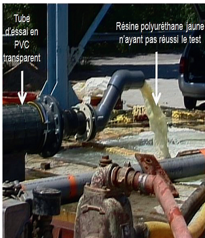
Figure 2.16 – Tests de résines au laboratoire EDF-TEGG en 1999 : écoulement turbulent dans des graviers avec une eau réfrigérée à 10 °C puis à 2 °C à travers un tube en PVC transparent, de 10 m de long / ©EDF
