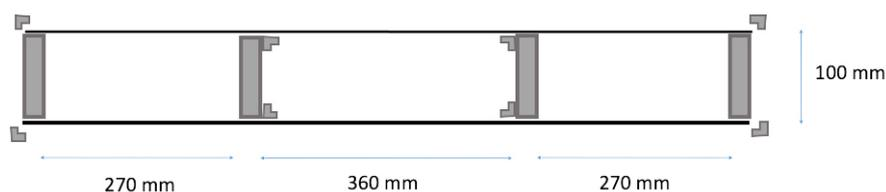
Figure 2. Caisson de la table de mesure : vue de profil
