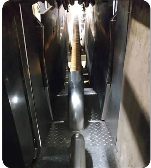
**Figure 29.** Système de contention et de convoyage des porcs au poste d'étourdissement. De type *restrainer* à bande porteuse ventrale, ce système permet un meilleur soutien des animaux.
