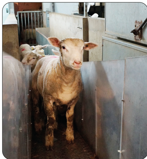
Figure 24. Ovins dans un couloir les conduisant au poste d'étourdissement. Ici, les parois ne sont pas assez hautes pour éviter que les animaux soient distraits ou apeurés par des événements extérieurs au couloir. Le sol et les parois sont métalliques, ce qui génère des reflets et ne facilite pas la progression des animaux. Ceux-ci peuvent refuser de marcher sur ce type de sol.
