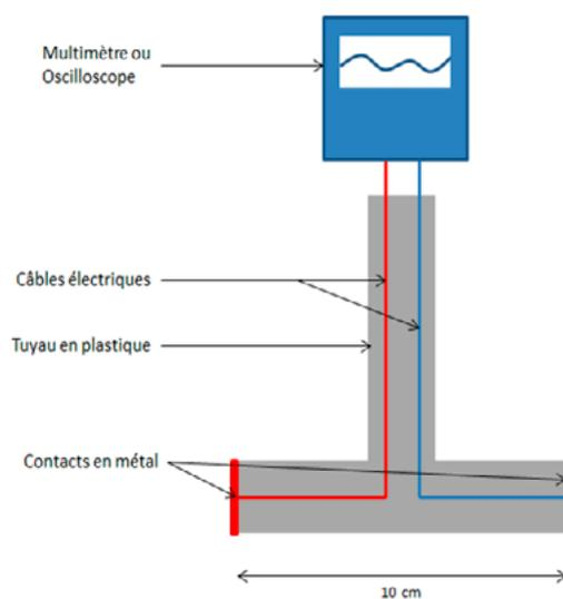
Figure B. Sonde Penny pour mesurer le gradient de tension.
