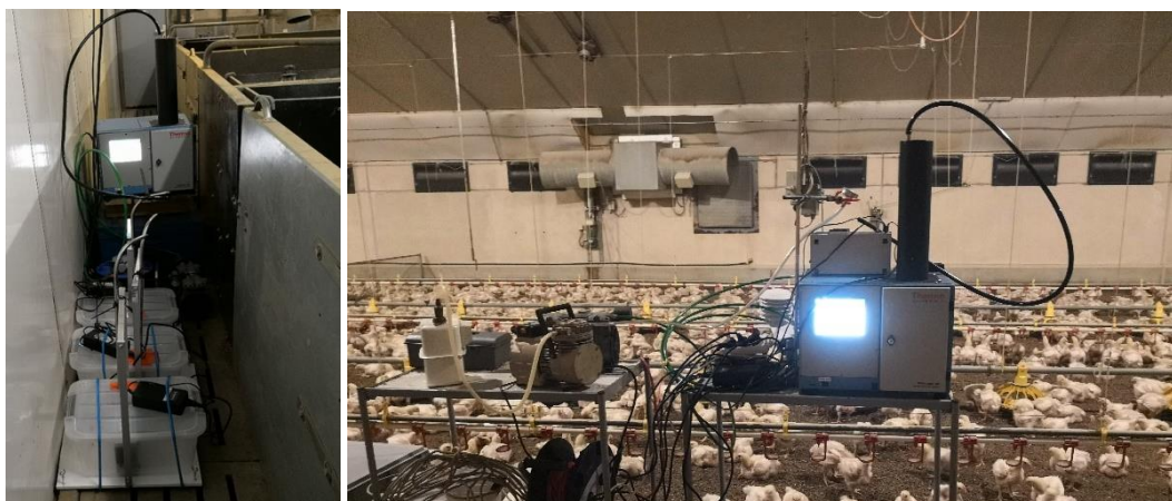
Figure 1 : Comparaison des compteurs Grimm avec la méthode de référence en élevage de porc (photo de gauche) et en élevage de volailles (photo de droite) (crédits photos : Ifip-Institut du Porc)
