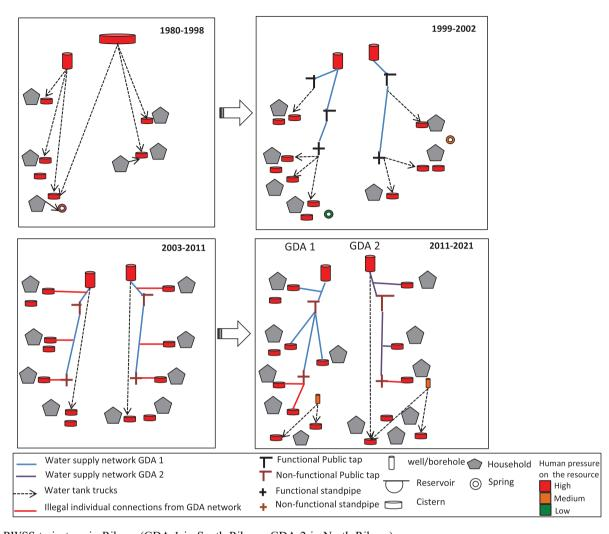
Fig. 6. RWSS trajectory in Rihana (GDA 1 in South Rihana; GDA 2 in North Rihana). Fig. 6. Trajectoire du système rural d'approvisionnement en eau à Rihana (Groupement de développement agricole [GDA] 1 au sud de Rihana, GDA 2 au nord de Rihana).
