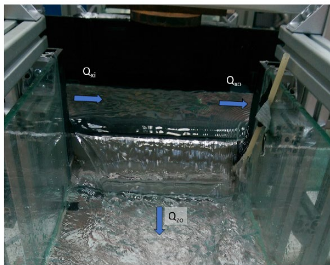
FIGURE 44. DÉVERSEMENT AU NIVEAU D'UN DÉVERSOIR LATÉRAL PILOTE.
