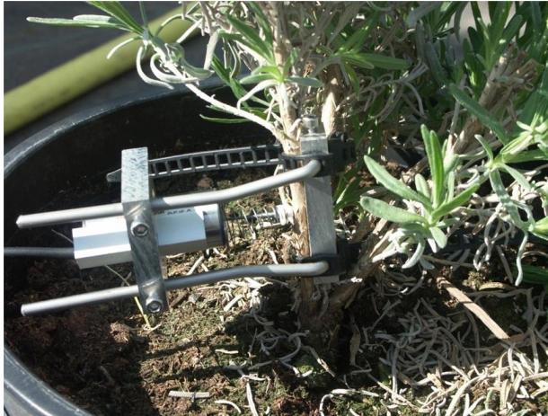
Figure 1 : Micro-dendromètre PépiPIAF sur une tige de lavandin
