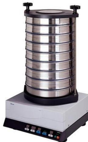
FIGURE II.8 – Tamiseur RETSCH utilisé.
