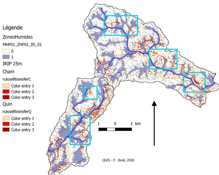
Fig.12: Positions des zones à fort potentiel de transfert - érosion liés au ruissellement intense par rapport aux ZHP et MHP
