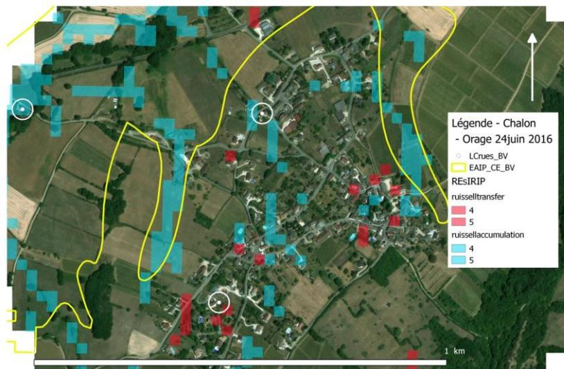
Il est aussi possible de comparer la cartographie des aléas IRIP à celle des hauteurs d'eau produites par le modèle LISEM du Delft Hydraulic Institute sur un sous bassin de notre zone d'étude du Grand Chalons.
