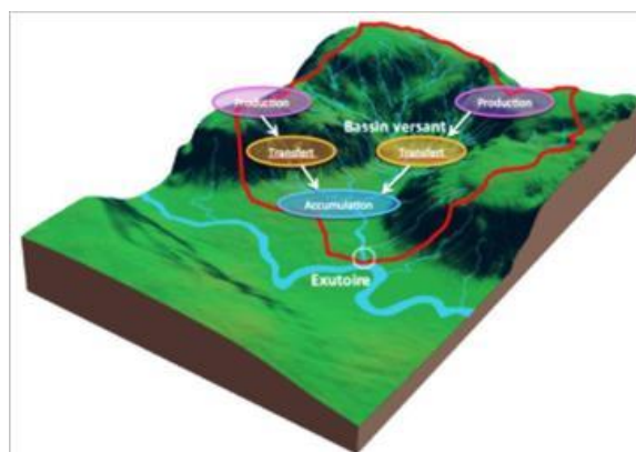
Figure 12 : Trois étapes de formations du ruissellement : production, transfert, accumulation (Lagadec, 2017)
