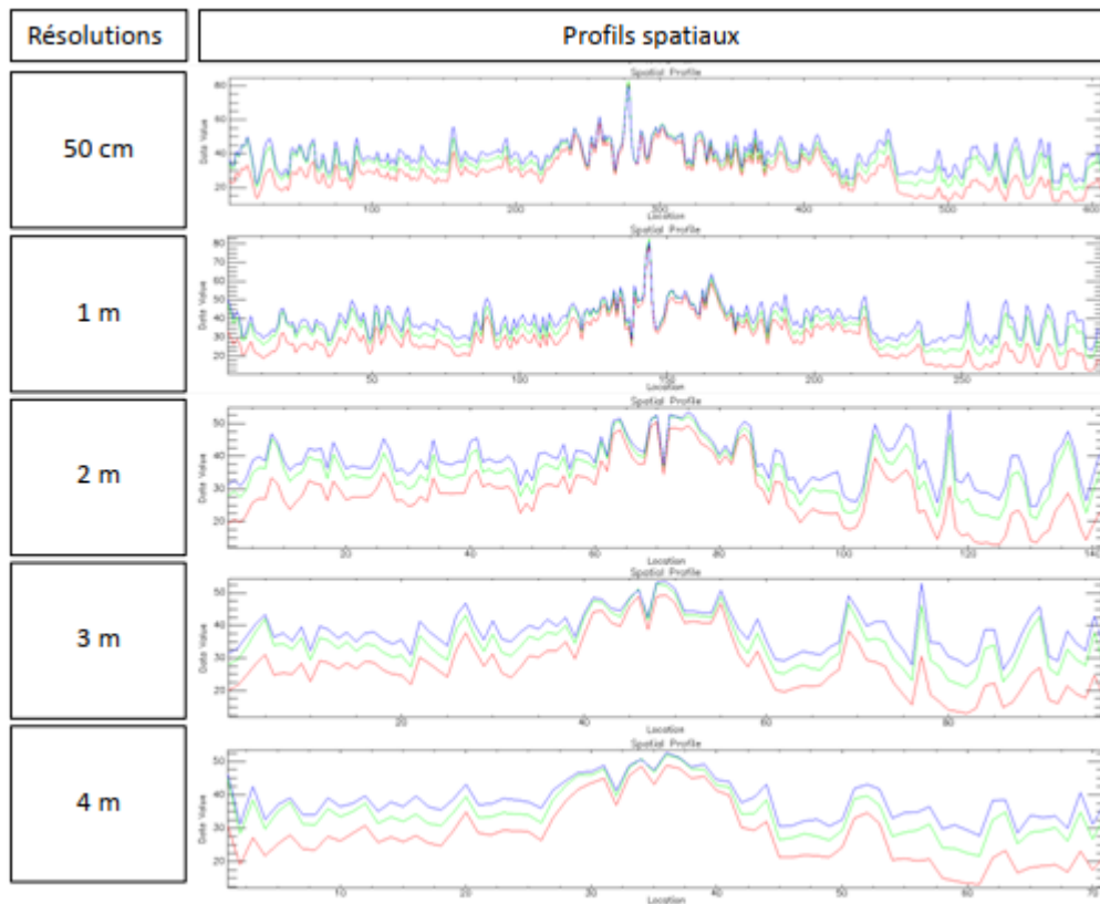
Profils spatiaux de l'aléa « dépôt » associés à une image Pléiades (daté du 03/11/2018) dont la résolution spectrale est progressivement dégradée à 1 m, 2 m, 3 m et 4 m.
