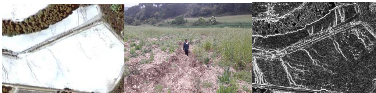
Figure 2 : Image Pléiades (03/11/2018) en « vraie couleur » (gauche), photo terrain (centre) et résultat filtre SOBEL associé (droite).
