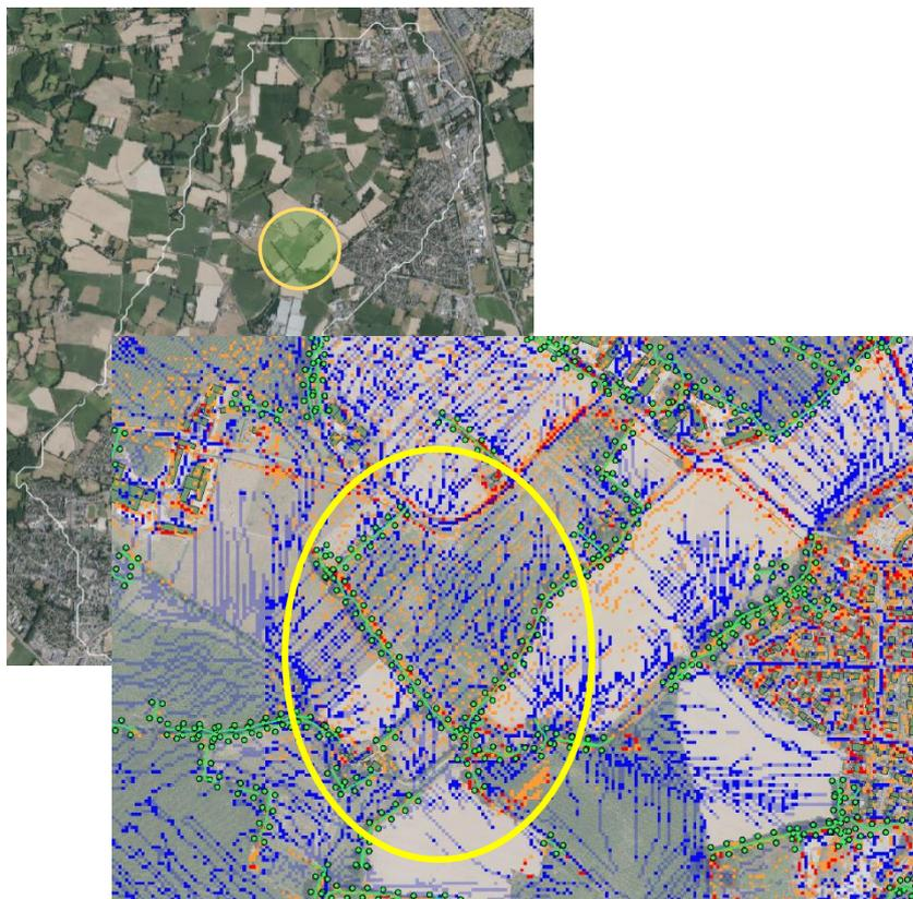
Exemple 2 / SMBV Tarn Amont : Effet haies bocagères sur accumulation (bleu) détectées par IRIP sur BV du Cernon en direction SW-NE par rapport au cours d'eau en direction NW-SE.
