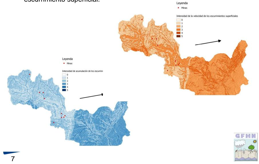
Modelización del proceso hidrológico de transporte y deposición en la corriente principal y la llanura de inundación.
