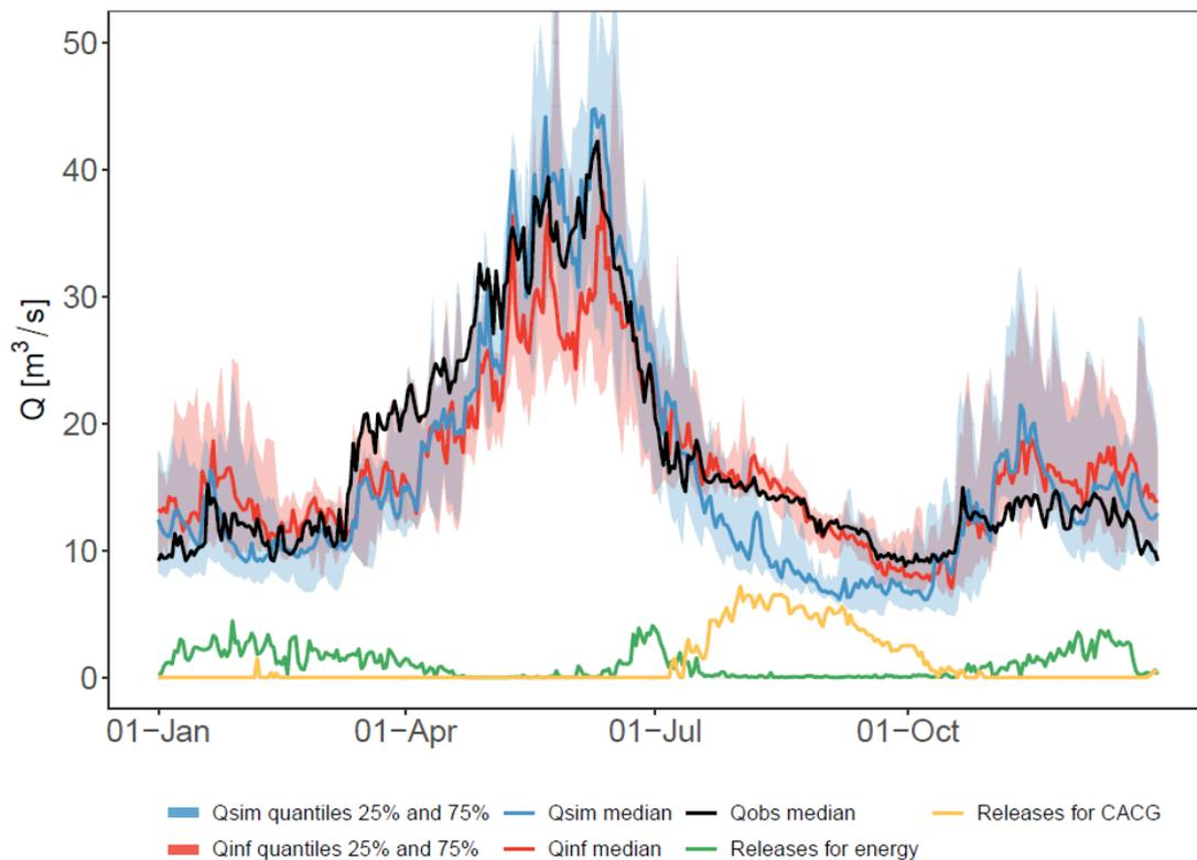
Figure 14: Hydrogrammes médians et courbes enveloppes définies par les premiers et derniers quantiles de la Neste à Sarrancolin – Comparaison aux débits turbinés et déstockés à la demande de la CACG sur la période 01/2002 -08/2014.
