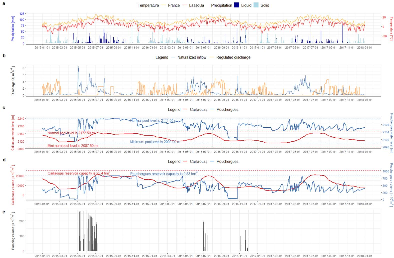
Figure 8 : Evolution des principales variables régissant la gestion des lacs-réservoirs de Pouchergues et Caillaouas sur la période 2015-2018 : forçages météorologiques issus de SAFRAN (a) ; débit entrant naturalisé et sortant influencé (b) ; niveau d'eau (c), volume stocké (d) dans les deux lacs-réservoirs du système Lassoula ; pompage de Pouchergues vers Caillaouas (e)
