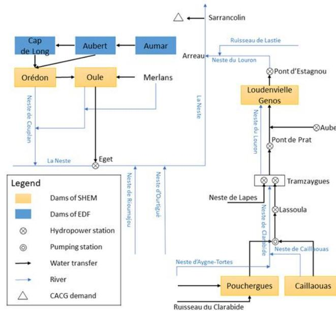
Figure 2 : Schéma synoptique des vallées des Nestes d'Aure et du Louron en amont de Sarrancolin
