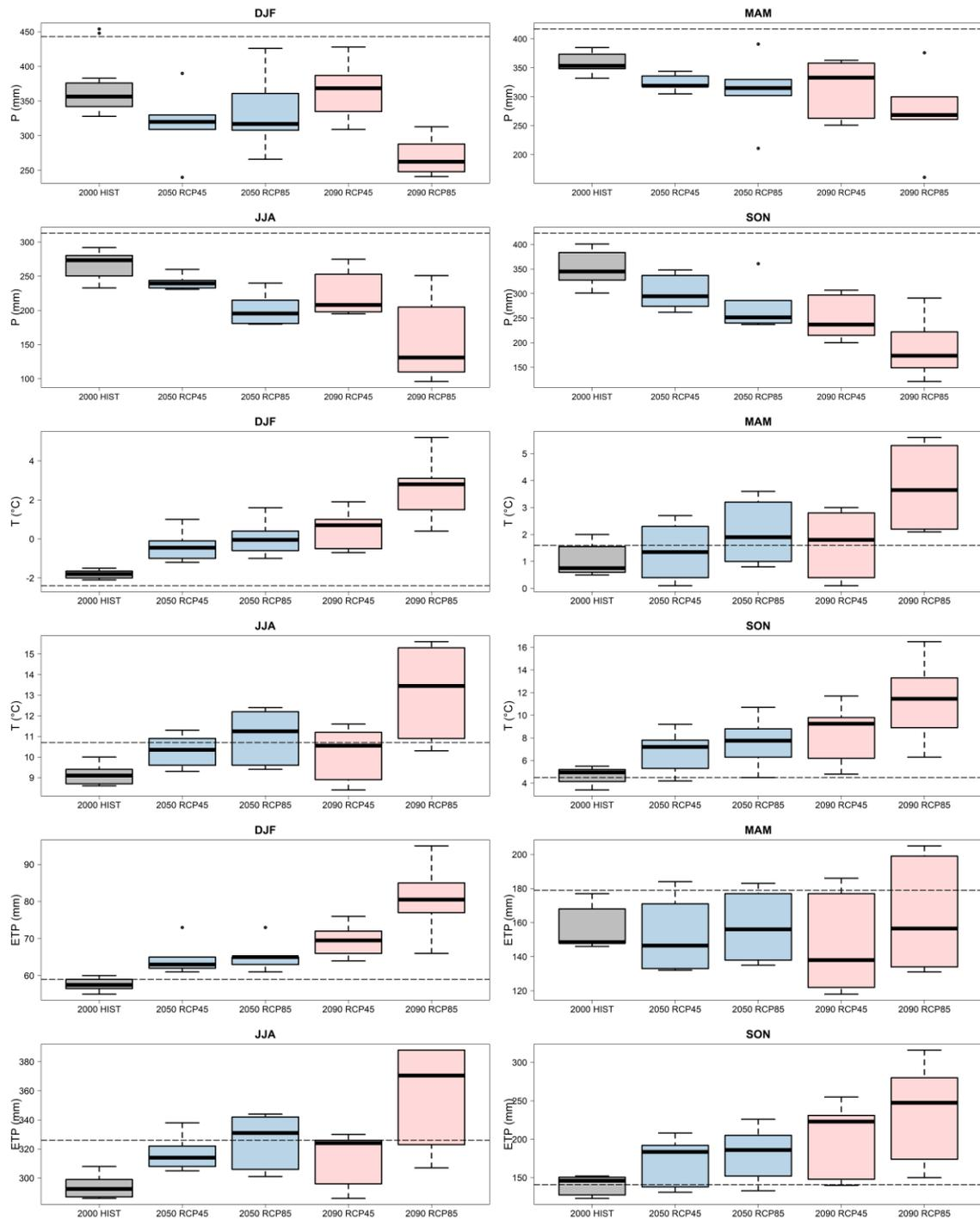
Figure 25: Evolution des moyennes interannuelles saisonnières de précipitations totales (P), de température (T) et d'évapotranspiration de référence (ETP) sur le bassin de l'Oule à différents horizons et pour les deux RCPs 4.5 et 8.5 (les droites en pointillé indiquent les valeurs extraites de la réanalyse SAFRAN-PIRAGUA)
