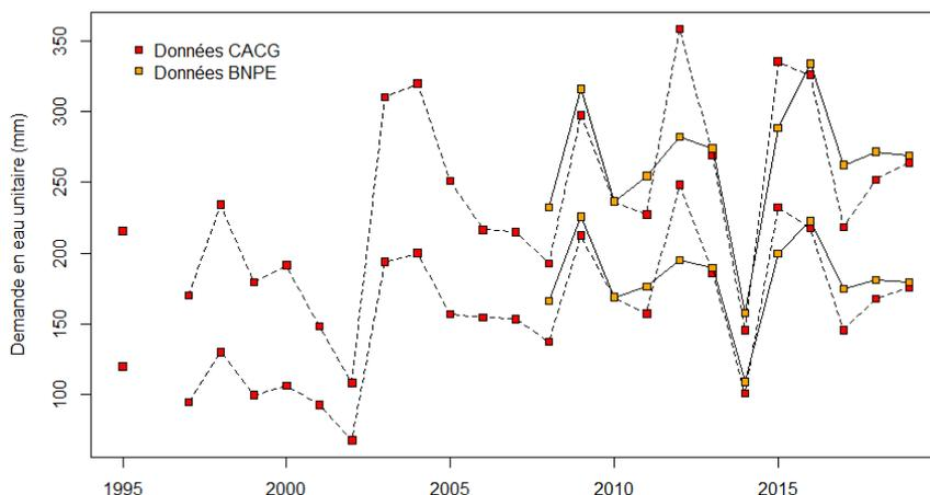
Figure 19 : Fourchette de demandes en eau unitaires déduites des données de prélèvement et d'une hypothèse sur la gamme des surfaces irriguées en maïs et soja sur le secteur d'étude
