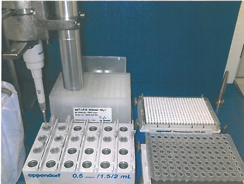
Figure 1 : les 4 socles du robot distributeur (tout est réfrigéré à 4°C)
