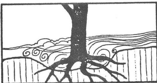
GROS TRONC, EFFOUILLEMENT ET TOURBILLONS.
